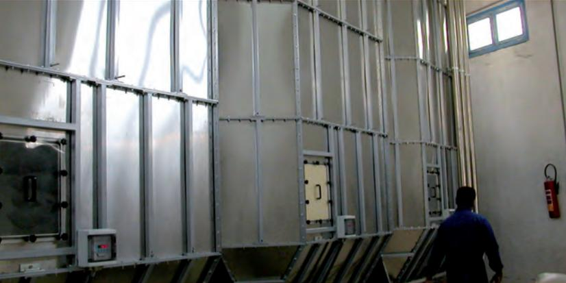
Silos modulari per interni in acciaio dotati di letto fluido per lo svuotamento uniforme e totale del prodotto.
