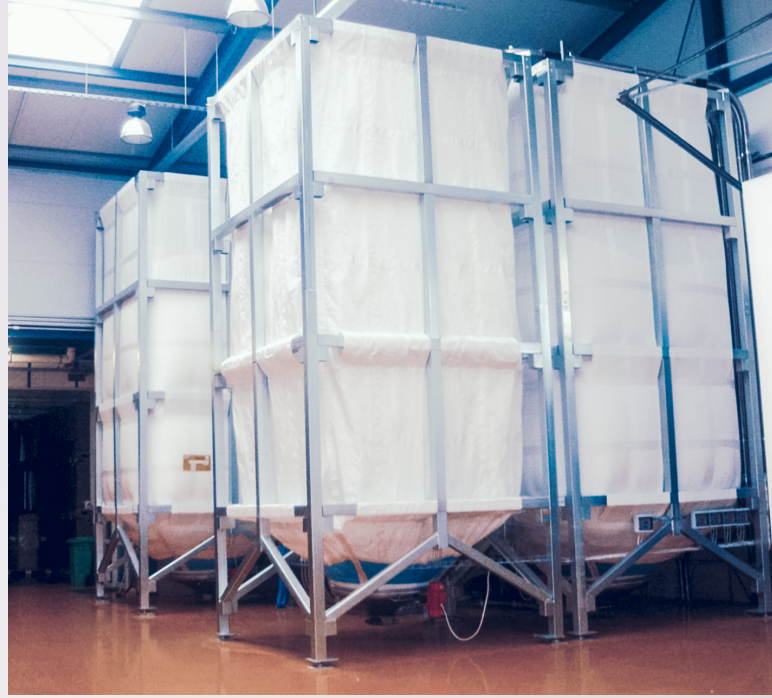
Silssystem con stazione per microingredienti, vibrosetaccio in linea pneumatica e controllo del peso; gruppo Silssystem
