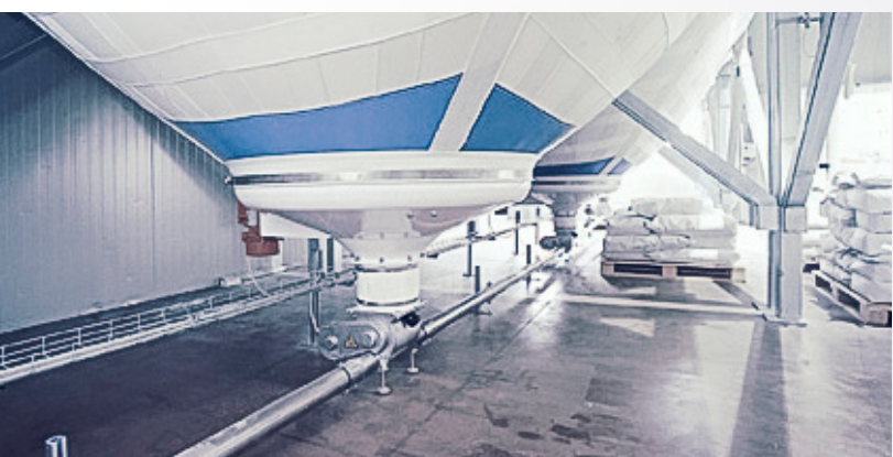
Estrazione con cono vibrante; Estrazione in aspirazione diretta
