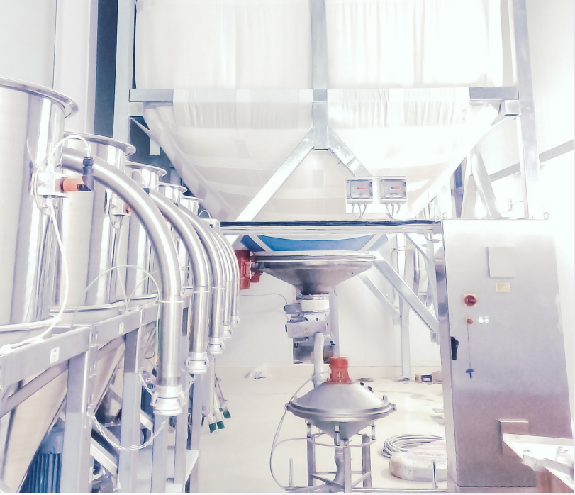
Silssystem con stazione per microingredienti, vibrosetaccio in linea pneumatica e controllo del peso; gruppo Silssystem
