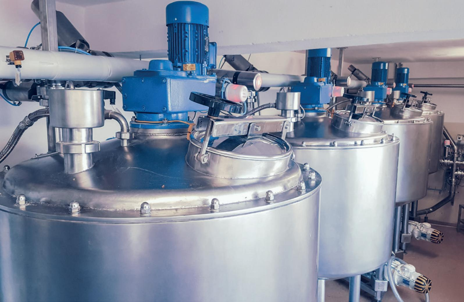
Gruppo preparazione lievito madre per volumi medi di produzione. Sopra: agitatore e portello di ispezione. Sotto: sistema di dosaggio a svuotamento totale
