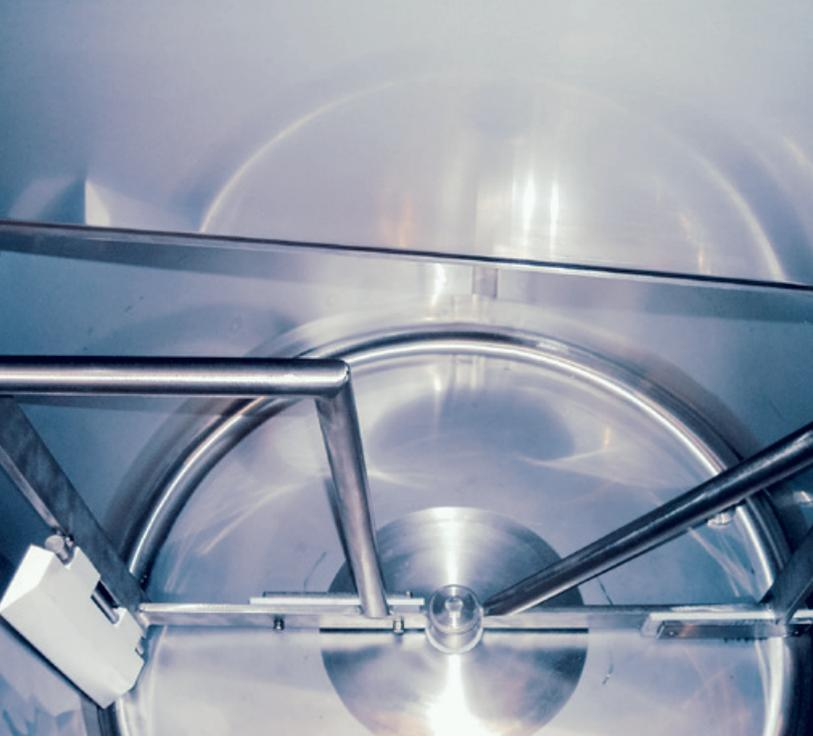
Agitatore con raschiatori per pareti e pavimenti con velocità regolabile, per una lavorazione delicata nella cisterna e per evitare la formazione di grumi
