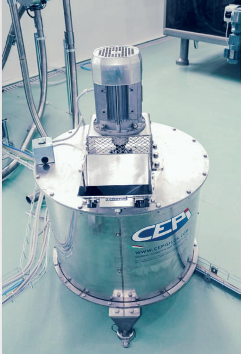
Sistema di recupero biscotti e dettaglio del mulino a coltelli
