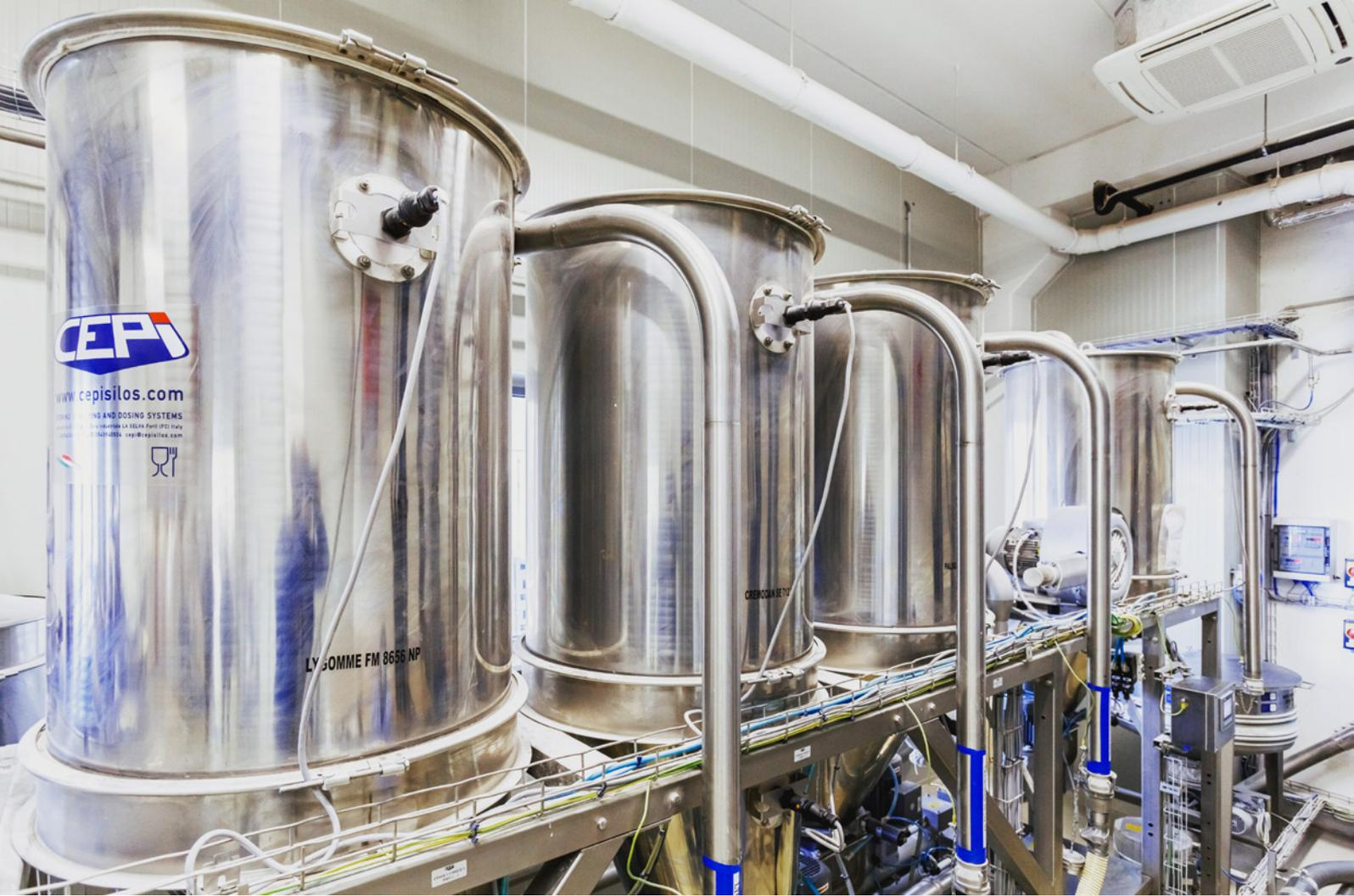
Stazione per microingredienti; Dettagli: sonda capacitiva, tubo di carico
