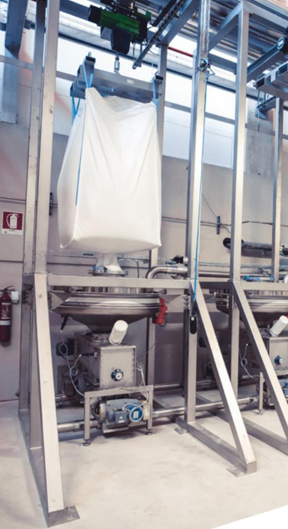
Stazioni di svuotamento sacchi di capacità variabile; adatte sia al carico dei silos che all'alimentazione diretta delle linee. In batteria per grandi volumi di produzione.
