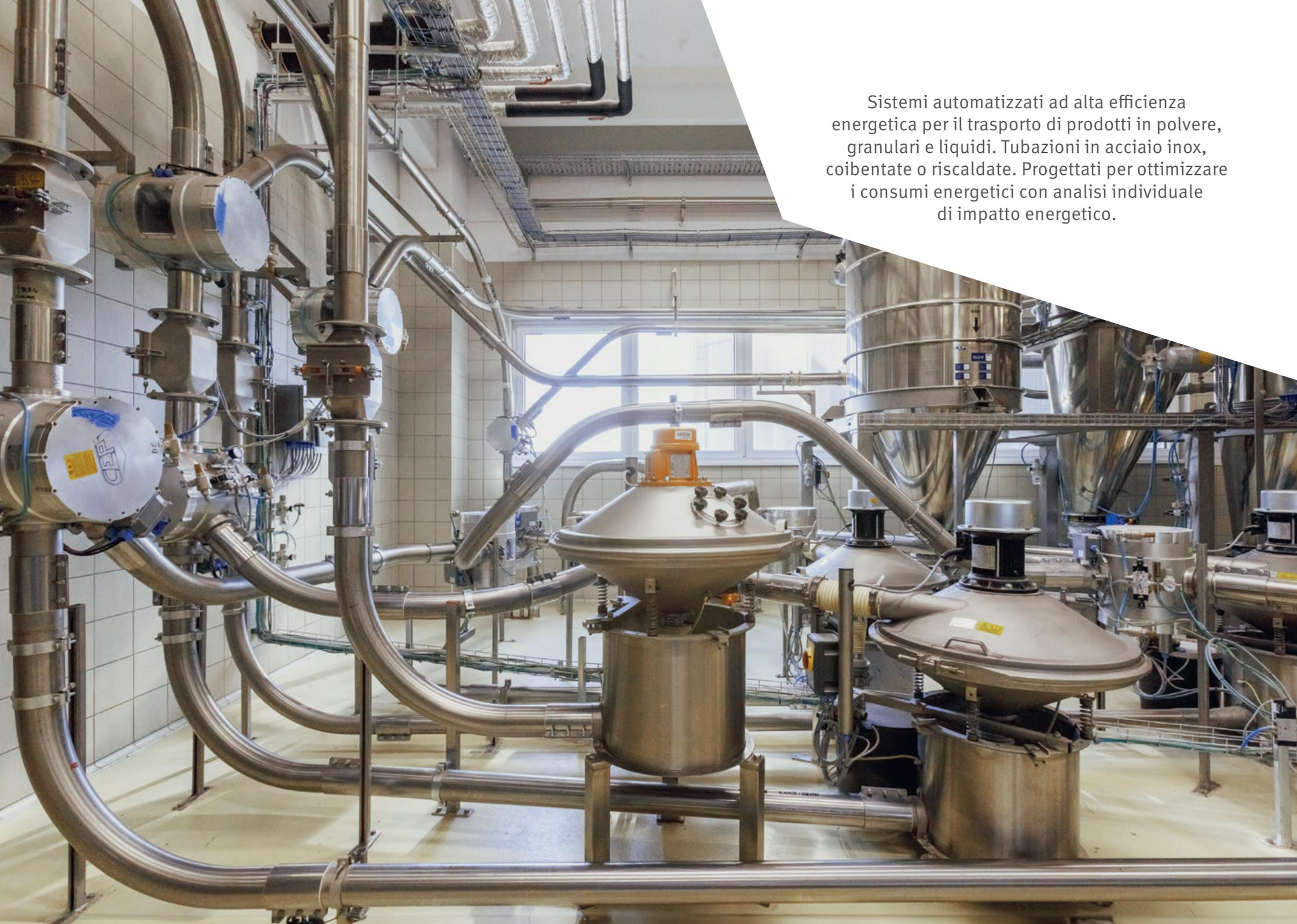
Sistemi automatizzati ad alta efficienza energetica per il trasporto di prodotti in polvere, granulari e liquidi. Tubazioni in acciaio inox, coibentate o riscaldate. Progettati per ottimizzare i consumi energetici con analisi individuale di impatto energetico.
