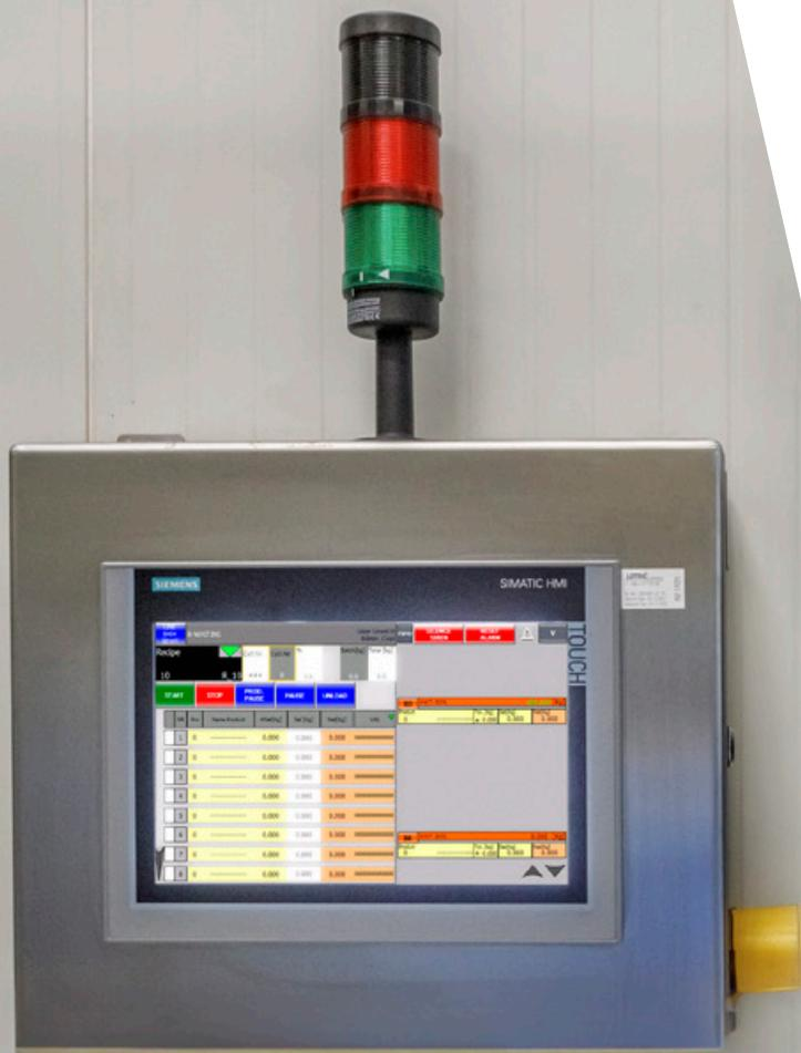
Touch panel per la gestione della produzione su linee singole o multiple.
