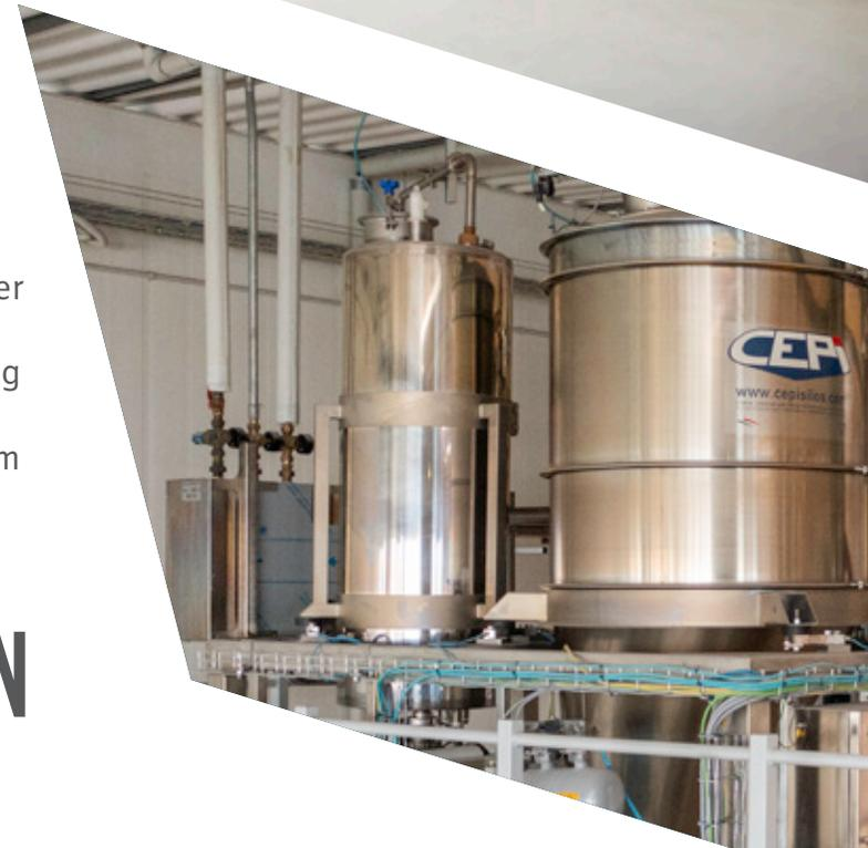
Homogenes Mischen von Pulvern auch bei Mengen unter 1% des Gesamtgewichts innerhalb von 3-5 Minuten
