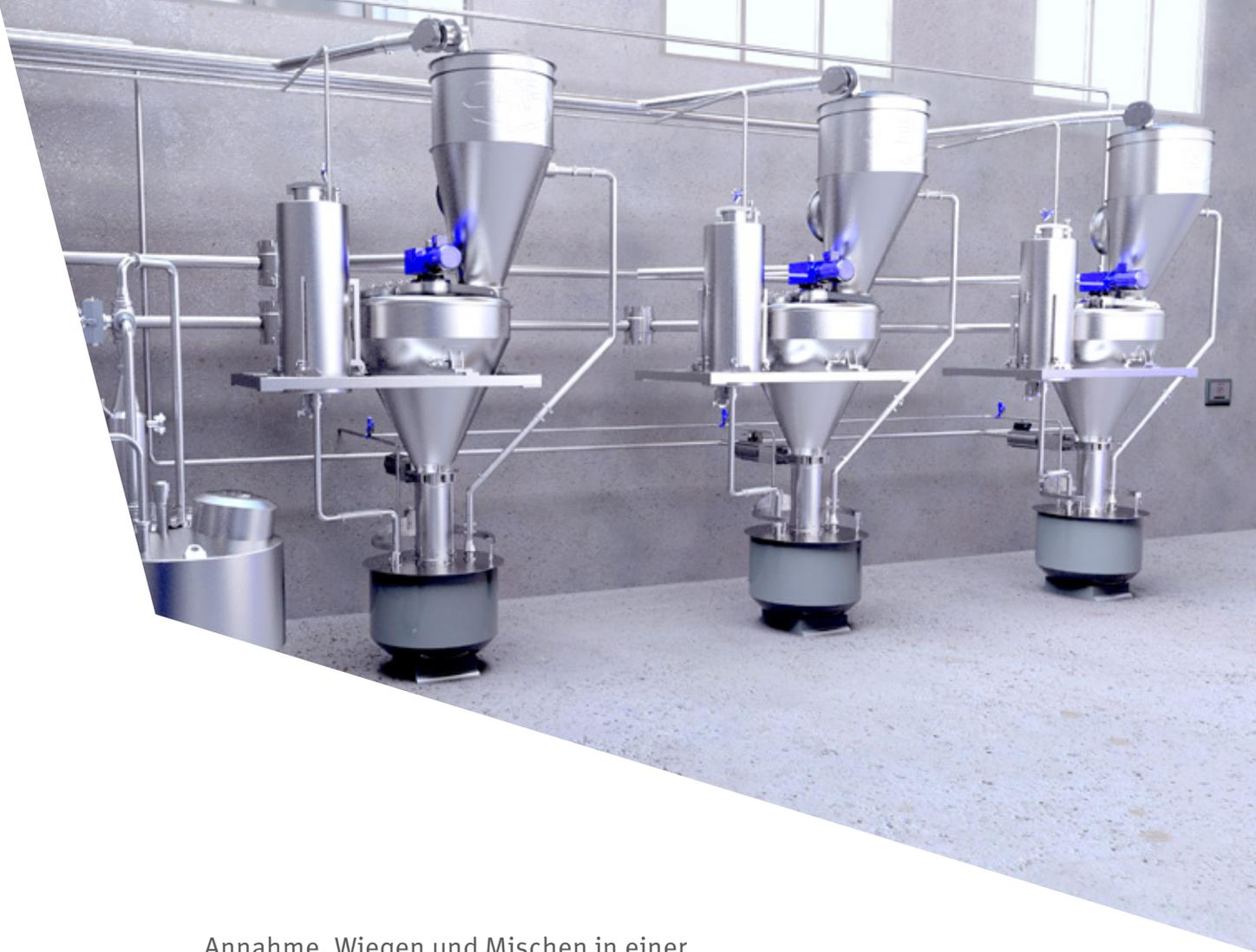
Annahme, Wiegen und Mischen in einer einzigen Einheit. Mit Vertikalmischer für die Herstellung von Vormischungen für eine Vielzahl von Lebensmittelbereichen.
