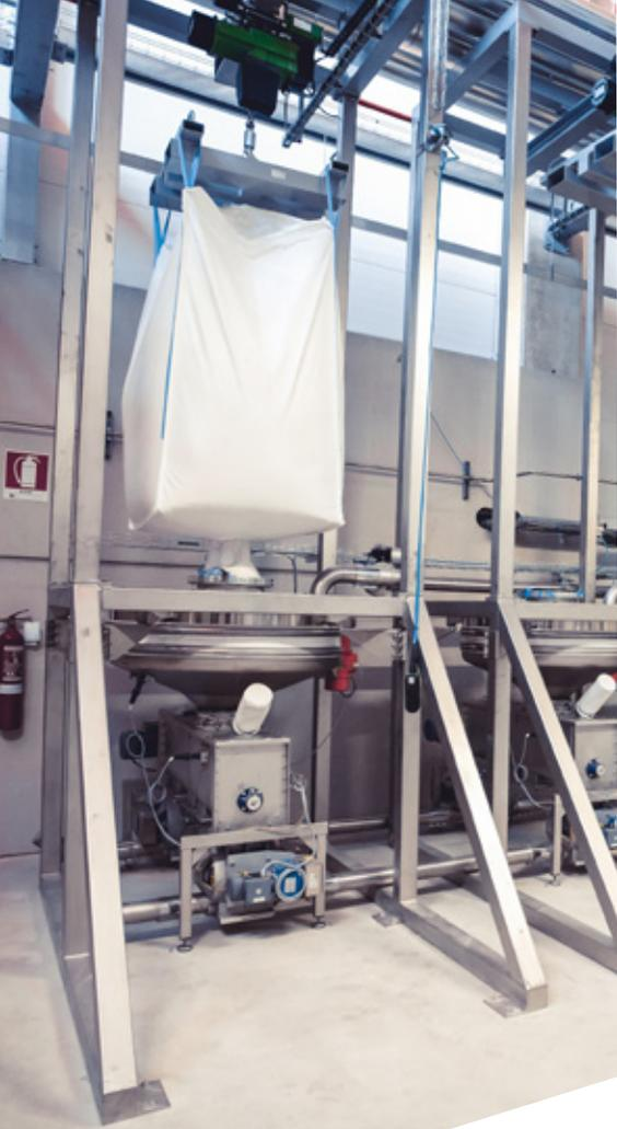
Sackentleerstationen mit variablem Fassungsvermögen, sowohl für die Beladung von Silos als auch für die direkte Beschickung der Linien geeignet. Einsatz in Batterien für große Produktionsmengen.
