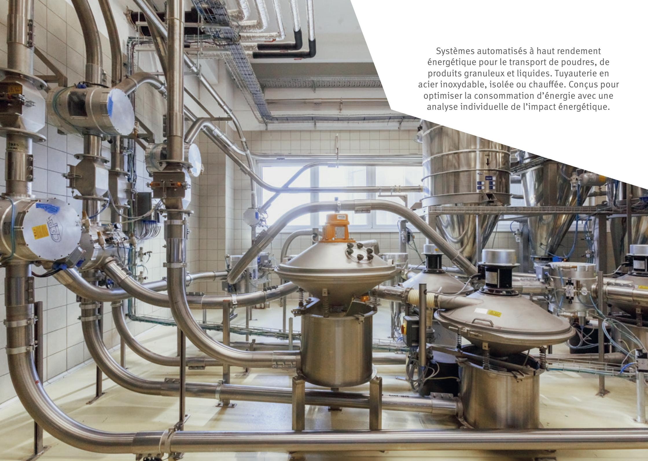
Systèmes automatisés à haut rendement énergétique pour le transport de poudres, de produits granuleux et liquides. Tuyauterie en acier inoxydable, isolée ou chauffée. Conçus pour optimiser la consommation d'énergie avec une analyse individuelle de l'impact énergétique.
